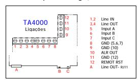
No interior da tampa da caixa do TA4000 encontrará uma etiqueta idêntica à reproduzida à esquerda com a indicação das ligações e que é um precioso auxiliar durante a instalação.
